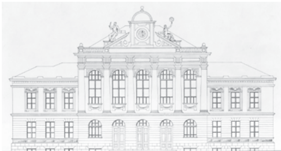
|Сл. 11. Гимназија у Смедереву, цртеж pročеља, вероватно цртано на основу главног пројекта (претпостављамо за потребе Изванредног комесаријата за обнову Смедерева) Извор: АЈ, МГ, VII- 051- Гимназија у Смедереву II/3
